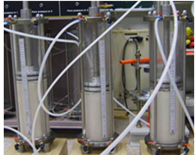
그림 1. 점토시료 제작을 위한 예압밀 시료 제작 장치
