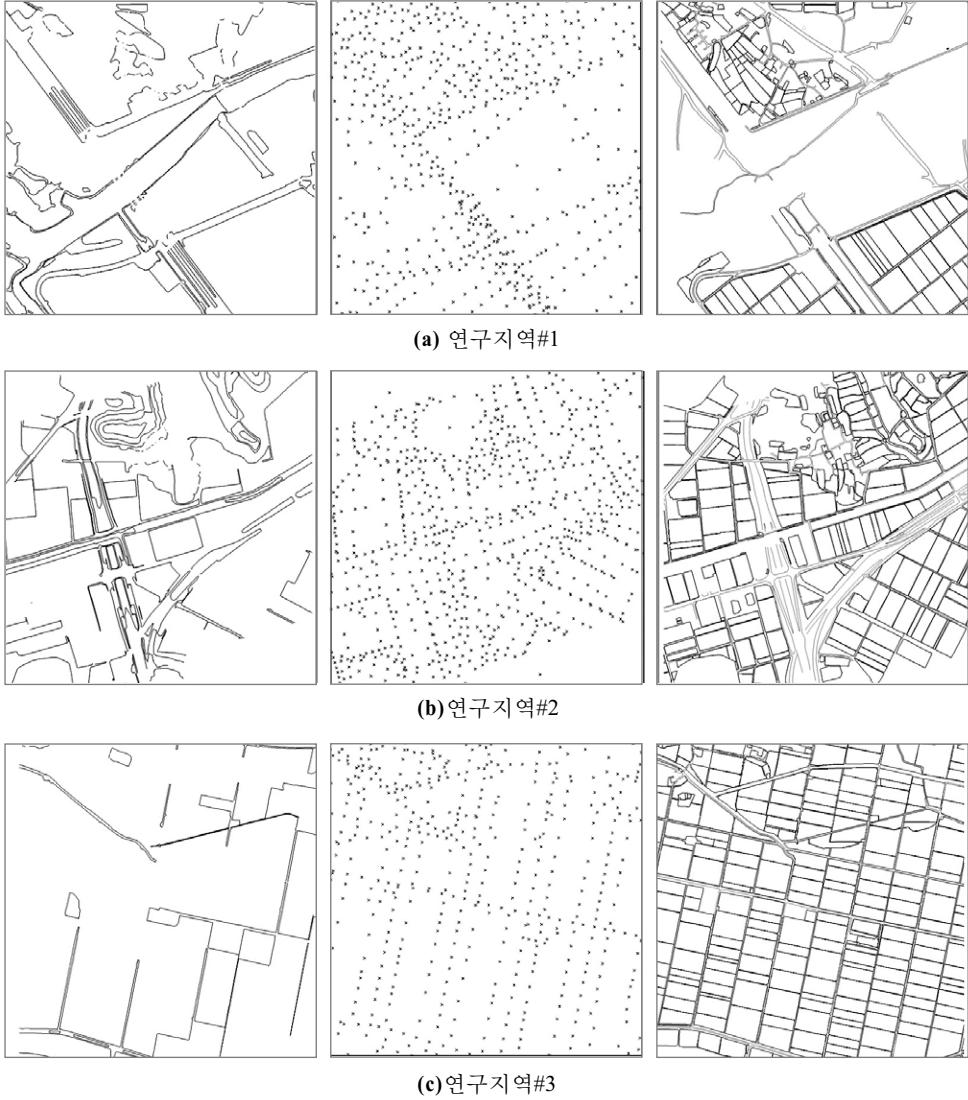
그림 4. 레이어 추출 (등고선(좌), 표고점(중앙), Break Line(우))
