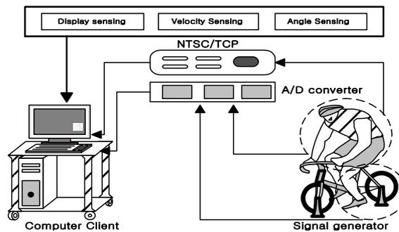
그림 1. 신호 발생 시스템 구성도
