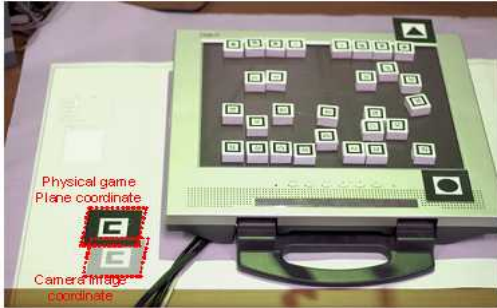
그림 5. 카메라와 프로젝터간의 매핑 문제점 Fig. 5. Mapping problem between camera and projector 4 PGA(Portable Game Assistant)
