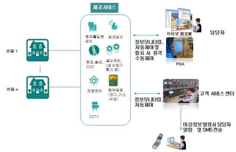
그림 7. 스마트폰을 이용한 원격 건물관리 시스템구성 Fig 7. Configuration of Remote Building Management System Using Smart Phone
