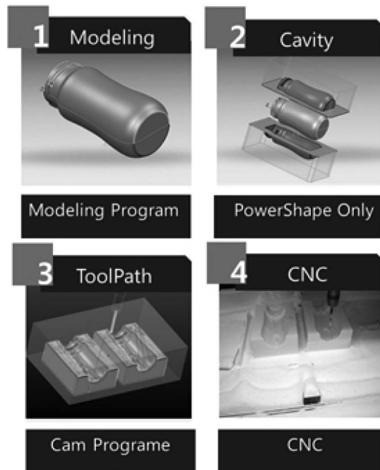
Fig. 1. CNC 장비의 제품원형 생산 공정.
