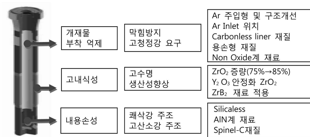
Fig. 9. 침적노즐(Submerged entry nozzle) 요구특성 및 비산화물계 내화재료.
