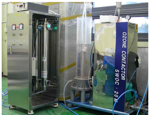
그림 3. 오존 분해장치 구조 Fig. 3. Ozone decompose system.
