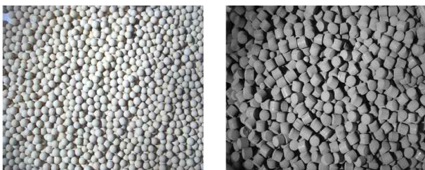
그림 5. 적용 촉매 (좌: 제올라이트계 우:망간계) Fig. 5. Catalysts(left: Zeolight, right: Manganese)
