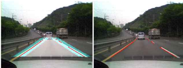
그림 21. 차선 검출 알고리즘 결과 이미지 (1) Fig. 21. Result image of lane recognition algorithm (1).
