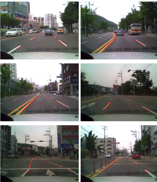
그림 22. 차선 검출 알고리즘 결과 이미지 (2) Fig. 22. Result image of lane recognition algorithm (2).
