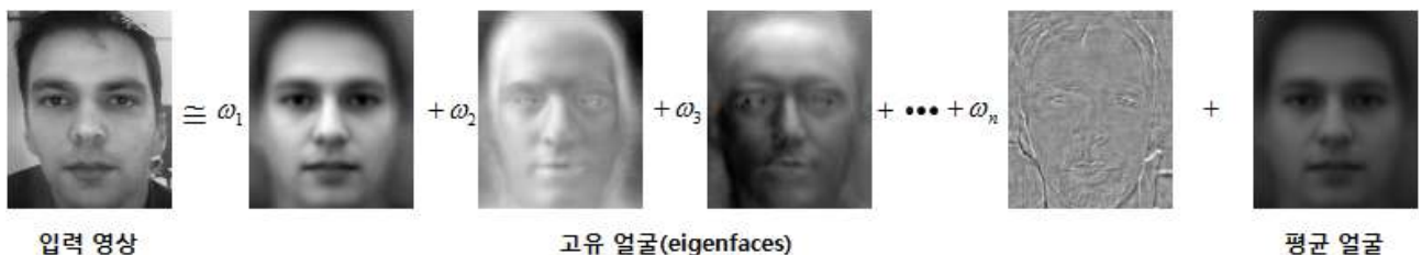
그림 2. 주성분 분석을 통해 추출된 학습데이터를 이용하여 재구성된 입력 영상 Fig. 2. Reconstructed face image using training data extracted by PCA.
