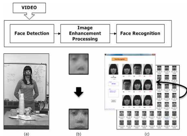
(a) 얼굴 검출 모듈(ace detection module) (b) 저해상도 영상 개선 모듈 (resolution enhancement module) (c) 얼굴 인식 및 식별 모듈(face recognition module)
