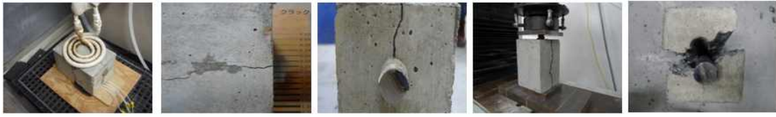
(a) 철근콘크리트 가열 (b) 균열발생 (c) 균열발생 (d) 철근 부착강도 실험 (e) 부착강도 실험 후
