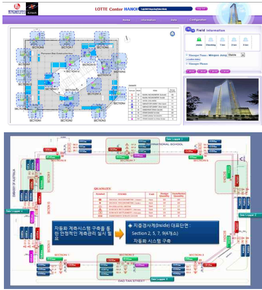
그림 2. 자동화 계측 설치 위치 및 개요
