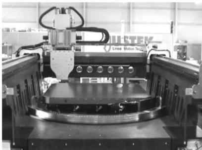
〈그림 1〉 초고속 가공 시스템
