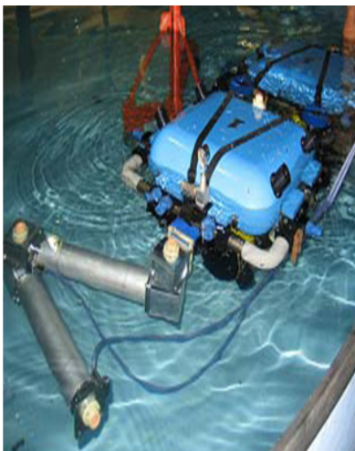
〈Fig. 8〉 3 d.o.f underwater manipulator of Japan
