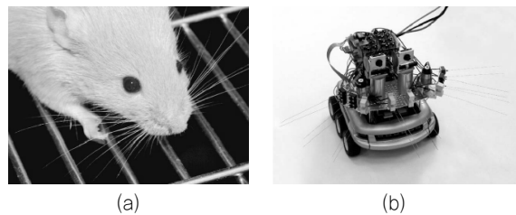
〈그림 3〉 쥐 수영센서를 모델로 하는 바이오로봇 (a) 쥐 수영 (b) 쥐 수영 모델 로봇 (reprinted from [8])
