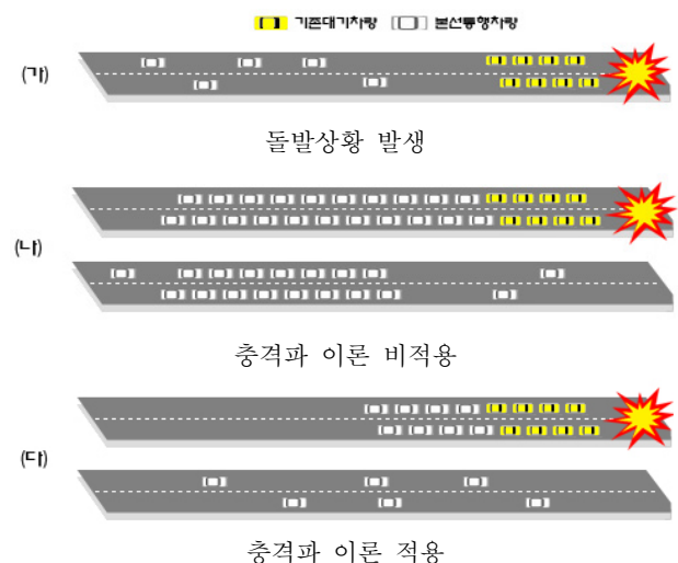
그림 2. 충격파 이론 적용/비적용 했을 때 대기행렬 Fig. 2. Queue with/without Shockwave
