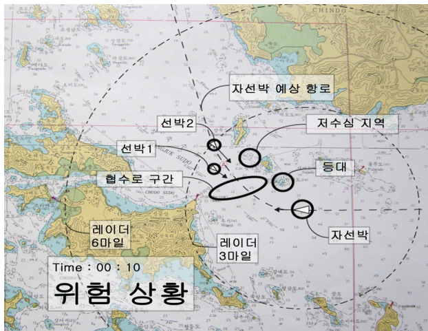
그림 10. 항행상황 시나리오 “위험 상황” Fig. 10. Navigational Situation “Dangerous Stage”
