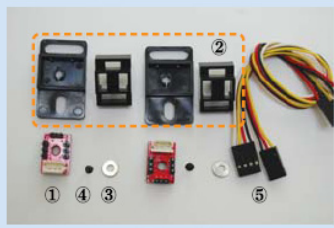
그림 4. 로봇제어부와 모터/센서간 결합용 커넥터세트
