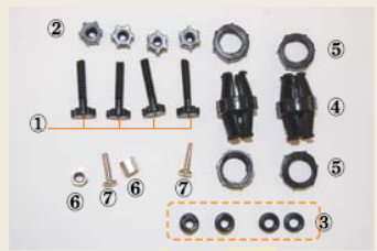
그림 5. 로봇 모터와 바퀴 간 결합용 부품 세트
