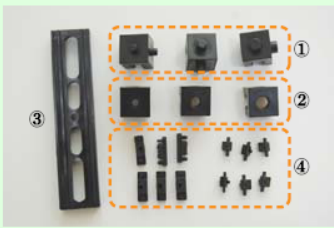
그림 3. 로봇 블록 간 결합용 슬라이딩 바 세트
