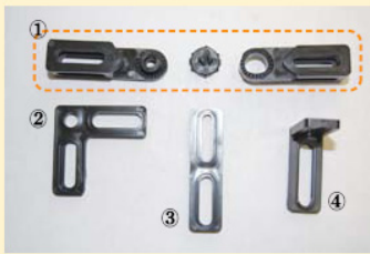
그림 2. 로봇 블록 간 결합용 프레임 세트
