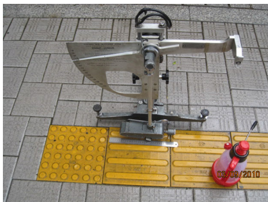
그림 9. BPT 장비의 고무슬라이더 길이 및 시험 사진
