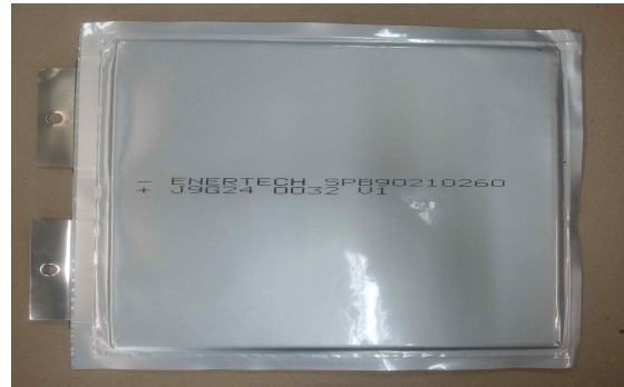
그림 10 실험에 사용된 리튬폴리머 전지 Fig. 10 Li-polymer battery for using experiment
