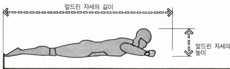
[그림 5] 엎드려 누운 자세의 환자 디맨션 (J. 파네로 & M. 젤니크, 인체공학과 실내공간, 이춘섭 역, 미진사, 1992)
