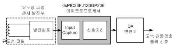
그림 2. 진동검출을 위한 유도성 근접 센서 모듈 구성도 Fig. 2. Block diagram of inductive proximity sensor module for vibration detect
