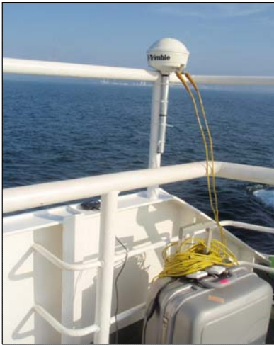
Figure 3: 선박항로 구간의 DGPS 전파 측정 구성
