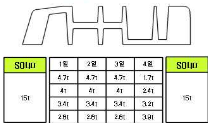
[그림 6] Stiffener 실물 단면 형상 및 두께
