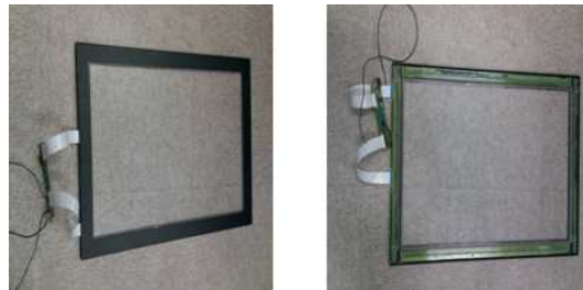
[그림 6] 자체제작한 적외선 LED기반의 터치 패널
