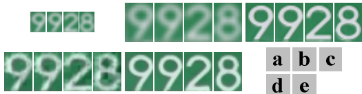
그림 9. 인공적으로 열화시킨 번호판을 각 숫자로 분리 후 복원한 영상 (a) 열화된 저해상도 숫자 영상 (b) 정방형 보간법 (c) 원본 영상 (d) 기존 방법 (e) 제안한 방법 Fig. 9. Reconstructed images by using artificial segmented license plate number image (a) Low resolution number image (b) Bi-cubic interpolation (c) Original image (d) Previous method (e) Proposed method
