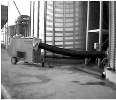
[그림 9] 이동식 곡물냉각기와 저온저장고를 이용한 벼 저장
