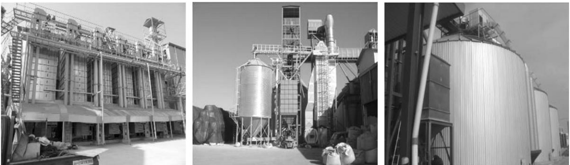
[그림 6] RPC에서 벼 건조에 사용되는 순환식, 연속식 및 상풍통풍건조시설
