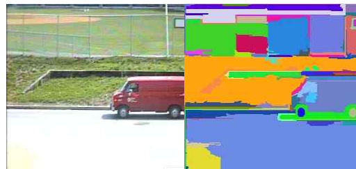
(a) 원 영상 (b) 그래프기반 이미지 분할 (a) Original Image (b) Image Segmentation
