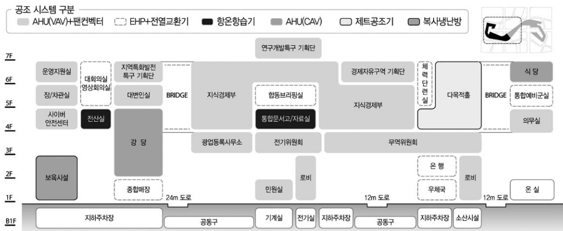
[그림 6] 실별 특성에 따른 공조조닝 계획 (산업과학기술연구원 공조 조닝)
