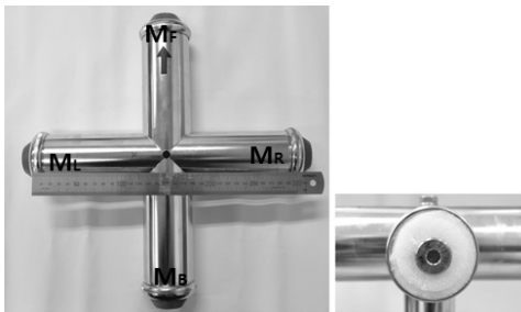
그림 2. 실험을 위해 제작한 십자 형태의 마이크로폰 어레이 구조 Fig. 2. Cross-type microphone array for experiment.
