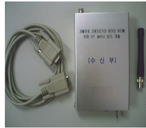
[그림 3] 재활치료용 전동자전거의 데이터 수신시스템 [Fig. 3] Data receive system of therapeutic rehabilitation moped
