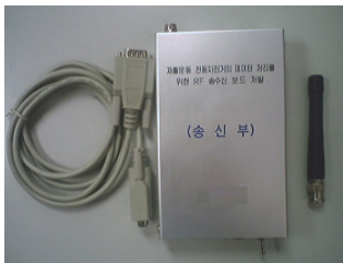
[그림 2] 재활치료용 전동자전거의 데이터 송신시스템 [Fig. 2] Data transmit system of therapeutic rehabilitation moped
