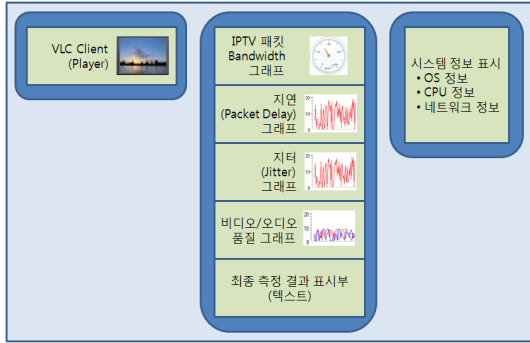
[그림 9] IPTV 품질측정 S/W (Active-X) 화면 구성도 [Fig 9] The display of IPTV QoS measurement S/W (Active-X)
