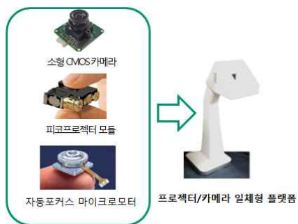
그림 1. 카메라/프로젝터 일체형 스탠드형태 플랫폼 Fig. 1. Monolithic stand type platform including the camera and the pico-projector
