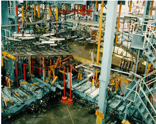
Fig. 1 날개에 패드를 부착하여 전기체 구조시험을 수행하는 예(F-16).
