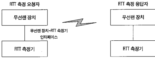
[그림 9] 무선랜기반 RTT측정 시스템 구조도 I
