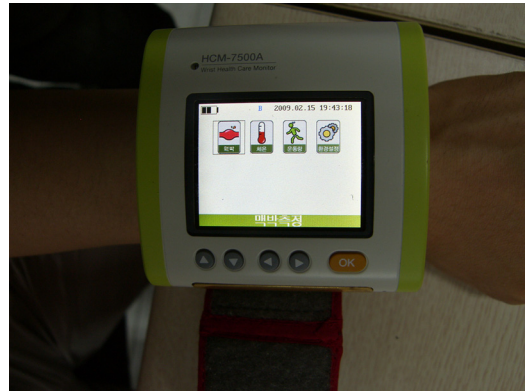
(a) 손목형 기기 및 초기 메뉴 화면 (a) wrist wearable device and initial menu display
