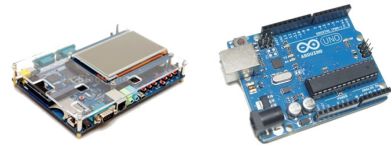
그림 3. 안드로이드 키트(S3C6410,왼쪽)와 아두이노 UNO (오른쪽) Fig 3. Android kit(S3C6410, left) and Arduino UNO(right)
