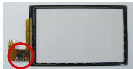
그림 8. 구현된 칩을 이용하여 실장테스트를 위한 터치 스크린 Fig 8. Touch screen for field test using implemented chip
