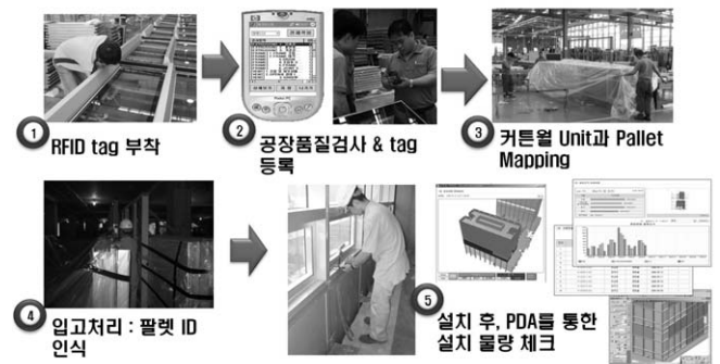
그림 6. 테스트 현장에서의 RFID 기반 물류 관리 시스템 적용 모습
