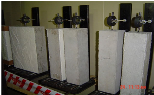
그림 2. 항온실 내의 다이얼게이지를 설치한 시편
