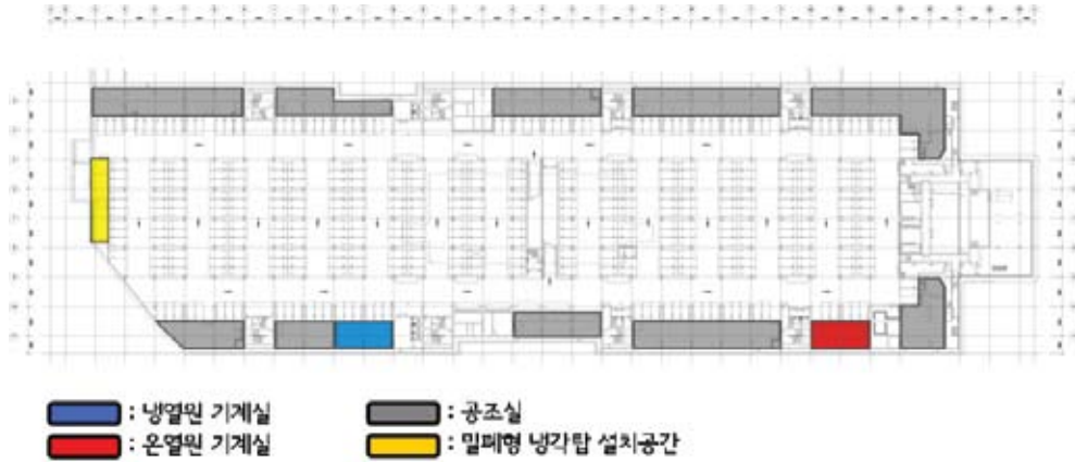
[그림 7] Thermal Labyrinth와 연결된 공조실 배치(지하6층 평면)
