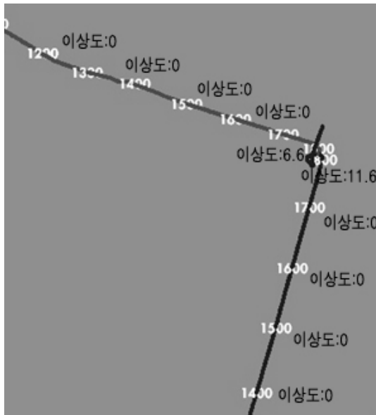
그림 10. 사고내역 2에서의 이상 항해 정도. Fig. 10. Degree of abnormal navigation in accident case 2.
