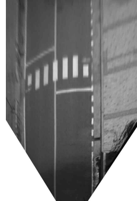
그림 9. 평면으로 시점을 변환한 영상 Fig. 9. The image from the view point changed to top view
