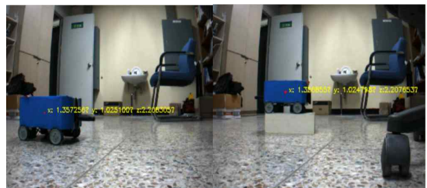
그림 5. 로봇의 3차원 좌표 표시 Fig. 5. Display of 3-dimensional coordinates of robot
