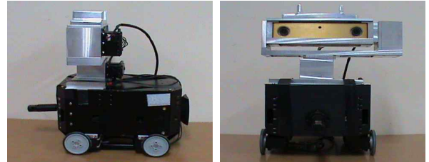
그림 2. 스테레오 카메라를 장착한 이동 로봇 Fig. 2. Mobile robot with stereo camera
