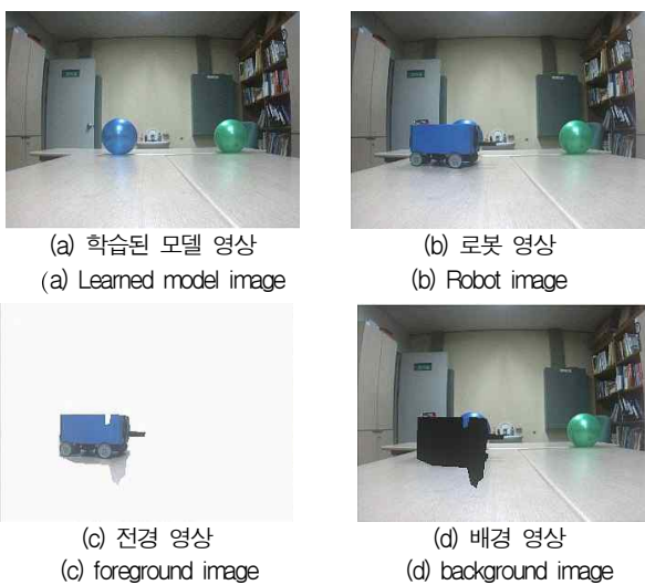
그림 4. 코드북 모델을 사용한 전경과 배경의 분리 Fig. 4. Segmentation of foreground and background images using code-book model
