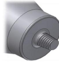
Fig. 8 FSW 실험에 사용된 Tool 형상
