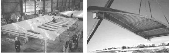
Fig. 2 노르웨이 Haugesund Marine Aluminium에서 FSW 적용 생산된 고속 패리용 패널 및 벽면구조
