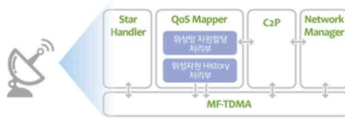
그림 11. 제안하는 네트워크 제어기 구조 Fig. 11. Proposing Network Controller Architecture
