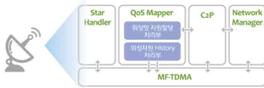
그림 9. 기존 네트워크 제어기 구조 Fig. 9. Before Network Controller Architecture
