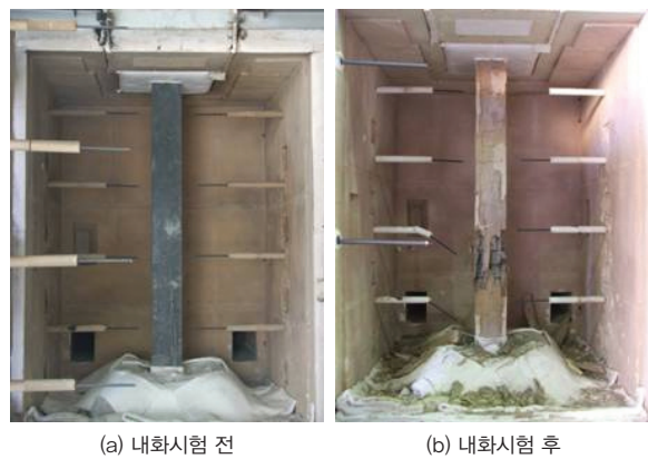
사진 1. 기둥부재 재하가열로를 활용한 고강도 콘크리트 내화시험 전후의 전경
