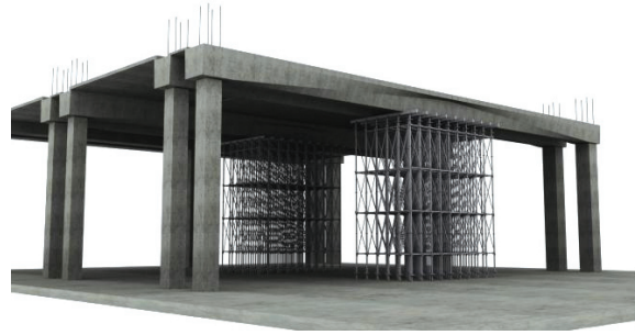
그림 8. 시스템 거푸집 계획
