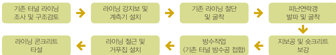
그림 3. 피난연락갱 시공순서
