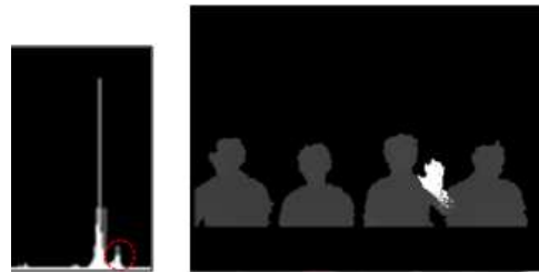
(a) (b) (그림 5) 깊이 영상에서 검출된 손 영역. (a) 인체영역 깊이 히스토그램, (b) 손 영역 검출 결과
